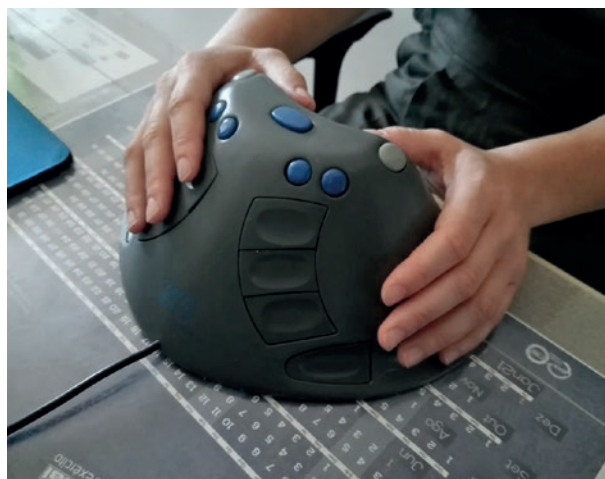
Figura 2 - Rato de restituição em 3D
