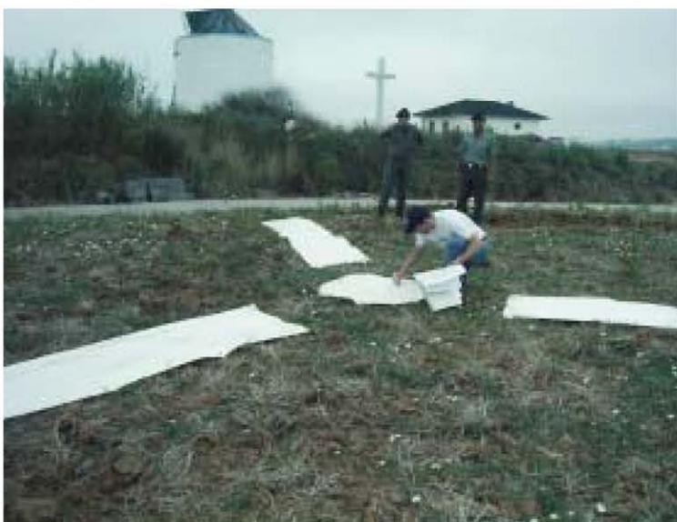
Figura 7 – Colocação de um ponto fotogramétrico artificial
