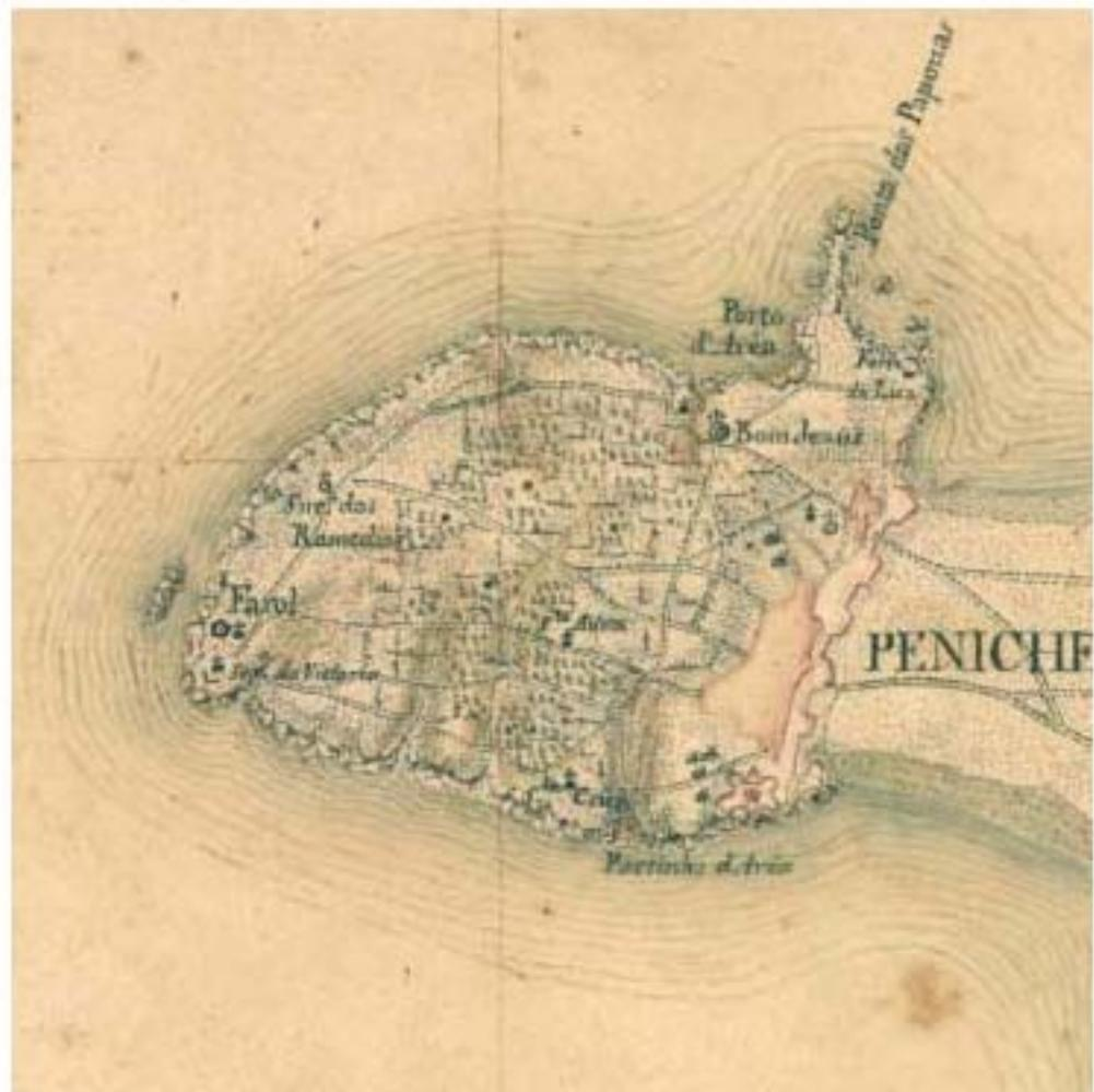
**Figura 3** – Extracto da carta topográfica da área entre o Cabo da Roca e o Cabo Carvoeiro, sem data e sem título, a que se reportam os trabalhos de triangulação referidos na figura anterior, feitos na mesma época por Neves Costa.
