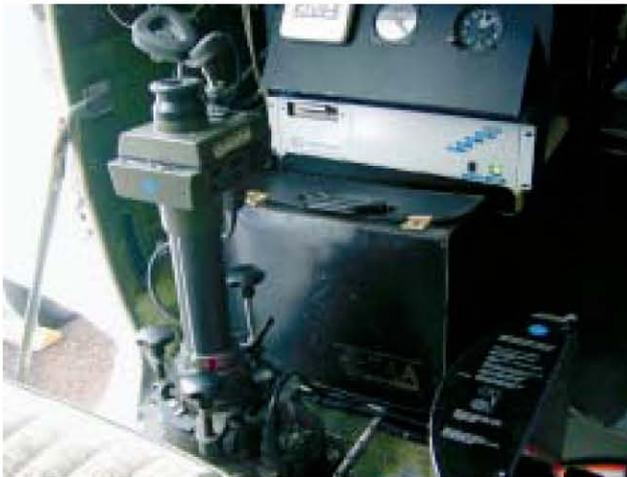
Figura 6 – Unidade de armazenamento e processamento de dados em voo
