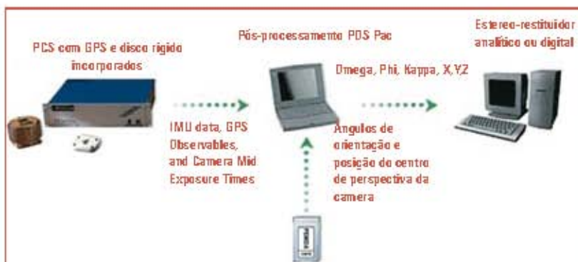
Figura 2 – Esquema da integração de sistema inercial com o pós-processamento
