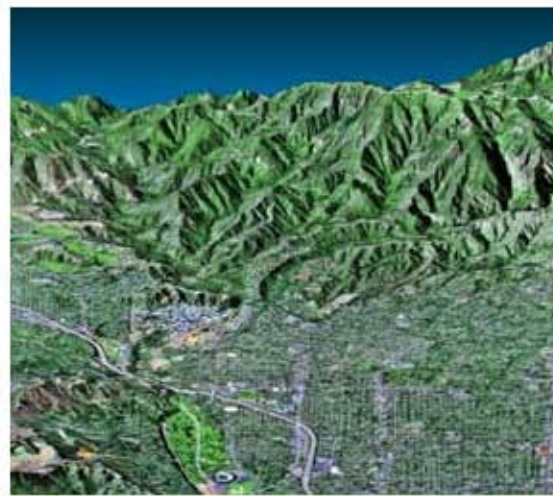
Figura 5 – SRTM DTED 2 combinado com imagem de satélite Landsat. Formatos manuseados, processados e disponibilizados ao público pelo NIMA
