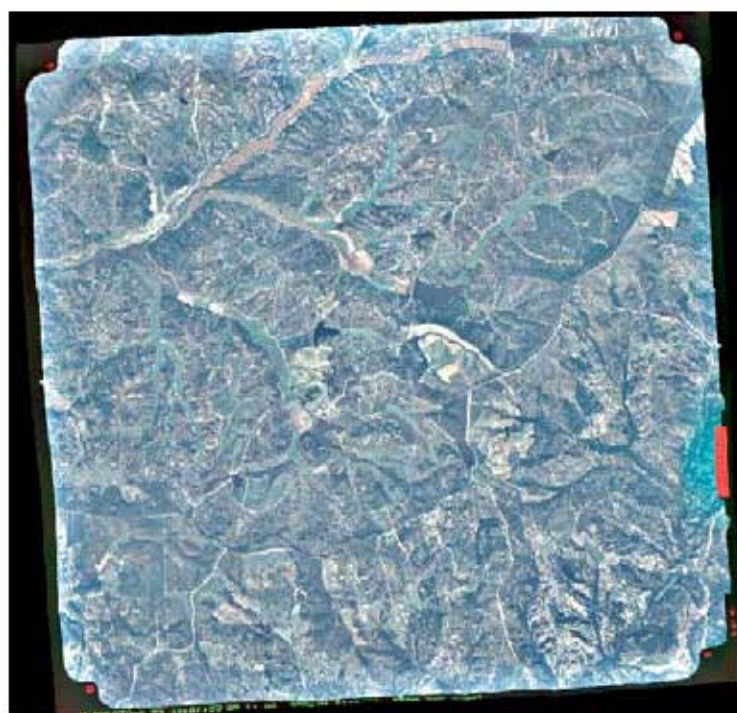
Figura 9 – Imagem ortorectificada depois de compensada radiometricamente ( dodging ).
