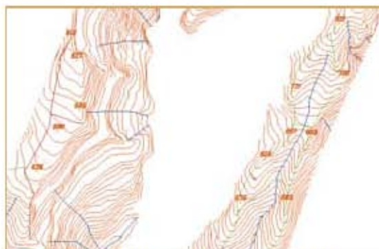
Figura 18 – Informação vectorial altimétrica com possibilidade de ser extraída (da fig. 17)
