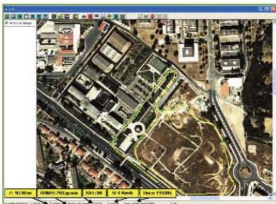
**Figura 5** – Ligação ao GPS, sendo possível visualizar o n.º de satélites, velocidade, hora, cota, rumo, data e as respectivas coordenadas. Fonte dos dados: IGeoE
