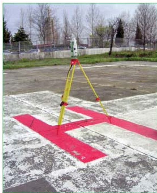
Figura 4 – SmartStation estacionada no TLOF
