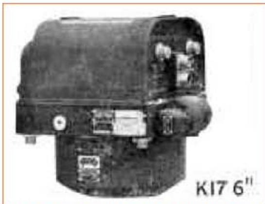
Figura 2 – A câmara aérea Fairchild K-17 com uma objectiva 6" Metrogon [Evidência in Camera, 1945]
