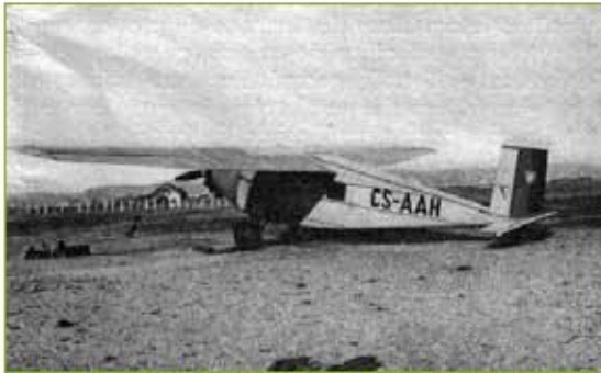
Figura 1 – O avião Messerschmitt "Pala Negra" utilizada pela SPLAL em voos aerofotogramétricos
