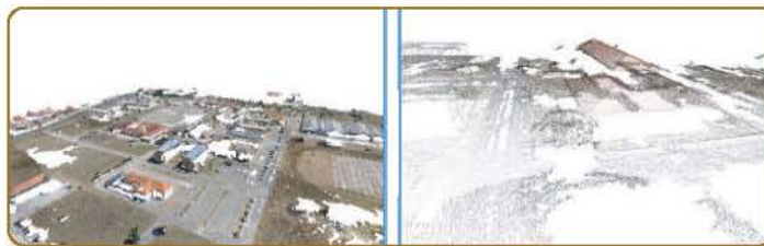
■ Figura 13 – Nuvens de pontos com valores de X, Y, Z e RGB.
