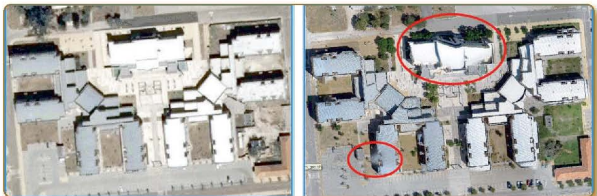
■ Figura 14 – Ortofotomapa obtido a partir de fotografia aérea (esquerda) e obtido a partir do UAV (direita)
