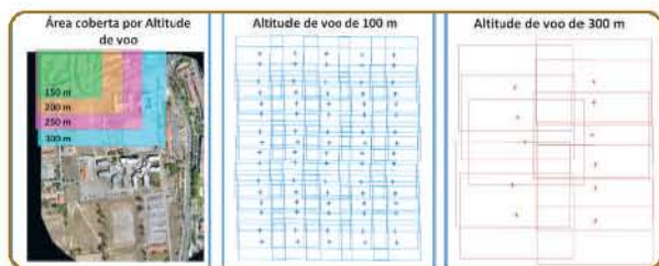
■ Figura 10 – Áreas abrangidas por fotografias tiradas a diferentes altitudes de voo e número de imagens necessárias para cobrir o bloco a diferentes altitudes.
