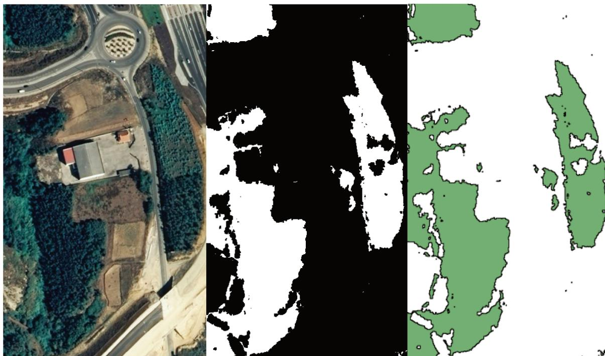
Figura 6 - Detecção de árvores em imagens. Da esquerda para a direita: ortofoto, máscara gerada pelo *AutoDTM* e áreas brancas transformadas em polígonos (extracto obtido do QuantumGIS)
