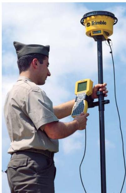
O recetor móvel RTK TRIMBLE 4800 que, combinado com outro recetor GPS fixo, permitia recolher as coordenadas com precisão centimétrica e de forma rápida, recorrendo à técnica “STOP and GO”.
