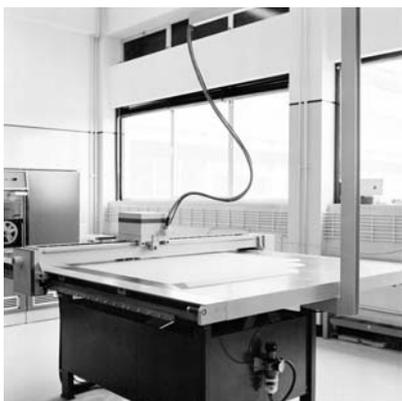
*O subsistema do desenho automático com a unidade de gravação e de controlo e a mesa digitalizadora com um sistema de vácuo para fixação das películas.*
