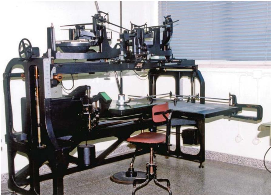
O restituidor WILD A6 com pantógrafo, utilizado na segunda metade da década de 40.
