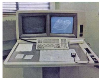
A estação gráfica utilizada na edição e no processamento dos dados, com a particularidade deste equipamento integrar a mesa digitalizadora e dois monitores, um a cores e outro monocromático.
