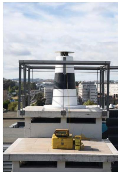
*Utilização do recetor GPS TRIMBLE 4000 durante uma sessão de recolha de dados para pós-processamento; a antena era colocada na vertical do ponto a coordenar e livre de obstáculos nas proximidades, para uma boa receção dos sinais de rádio-frequência.*
