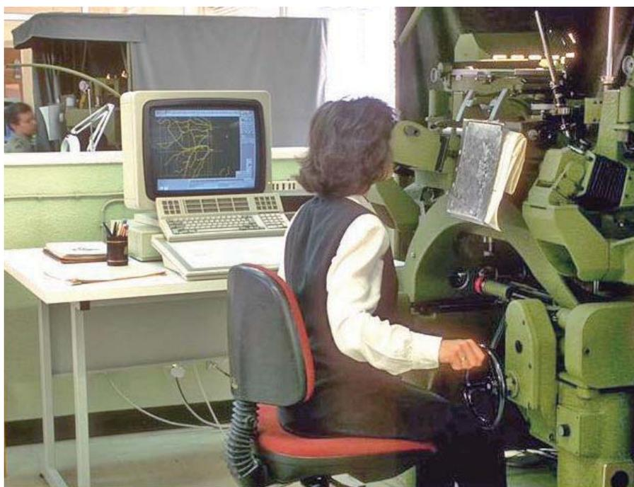
A estação fotogramétrica *InterPro* permitia a gravação dos dados em disco rígido e o teclado, com o menu de restituição e uma pequena mesa para edição dos dados, possibilitava a introdução de correções nos elementos gráficos obtidos.
