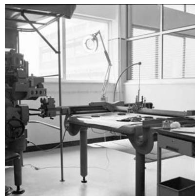
*O subsistema de aquisição de dados, com a unidade de gravação, o estereorrestituídor Wild A8 e o coordenatógrafo.*
