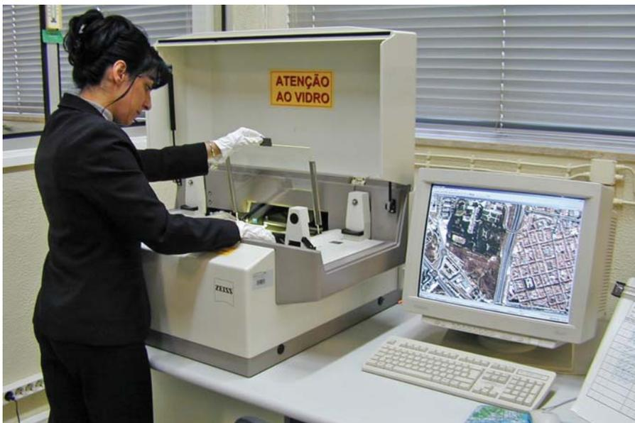
O scanner de alta resolução PhotoScan TD, com sistema de digitalização a partir do diapositivo individualizado ou diretamente da bobina com o filme aerofotográfico.
