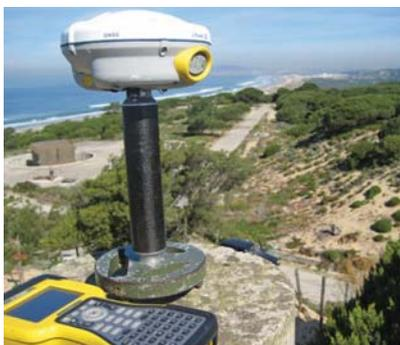
Instalação do recetor móvel GNSS Trimble R8 num vértice geodésico e respetiva caderneta de campo eletrónica.
