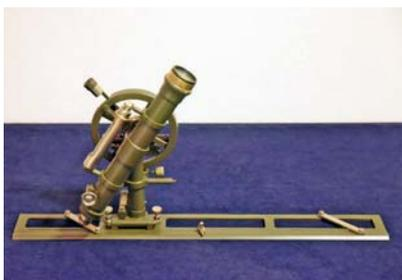
*Alidade de óculo Max-Hilderbrand. Colocada sobre uma prancheta topográfica destinava-se a visar objetos cuja direção se pretendia fixar em desenho topográfico.*
