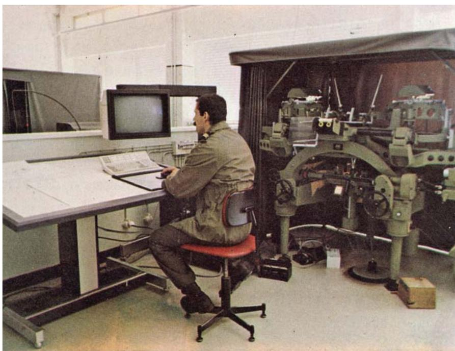
*A aquisição de dados: o restituidor acoplado à estação gráfica InterMap e a mesa digitalizadora, com cursor e menu de restituição.*
