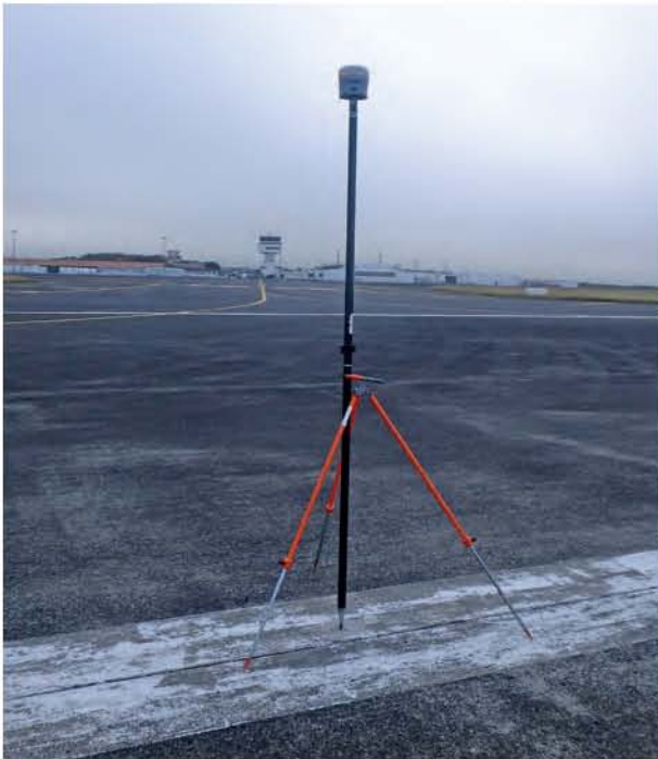
Figura 6 - Medição de um ARP com recetor GNSS Trimble R10
