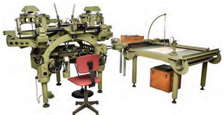
Figura 4 - Estereorrestituídores analógico Wild A8
