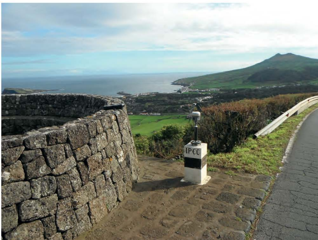
Figura 8 - Medição de Vértice Geodésico em modo estático
