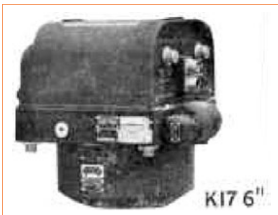
Figura 2 – A câmara aérea Fairchild K-17 com uma objectiva 6" Metrogon [Evidence in Camera, 1945]
