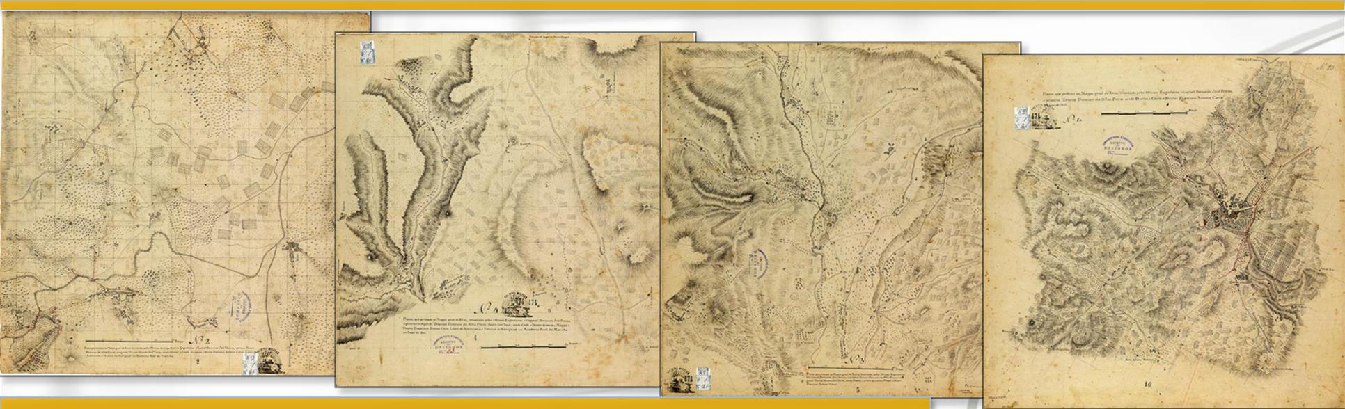
**Minutas da Carta Geral do Reino de Portugal (1:10 000), levantadas entre cerca de 1800 e 1804 sob a direcção de Ciera (9 das 17 folhas estão datadas de 1800 a 1803). A numeração sugere provavelmente a sequência dos levantamentos; nas margens indicam-se os pontos de ligação com as folhas contíguas.**
