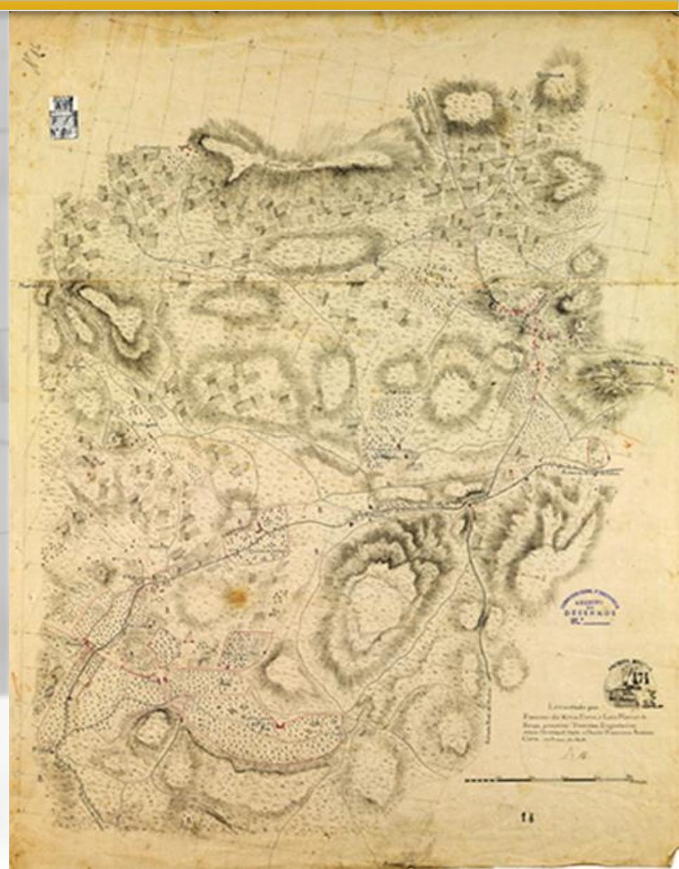
**Minutas da Carta Geral do Reino de Portugal (1:10 000), levantadas entre cerca de 1800 e 1804 sob a direcção de Ciera (9 das 17 folhas estão datadas de 1800 a 1803). A numeração sugere provavelmente a sequência dos levantamentos; nas margens indicam-se os pontos de ligação com as folhas contíguas.**
