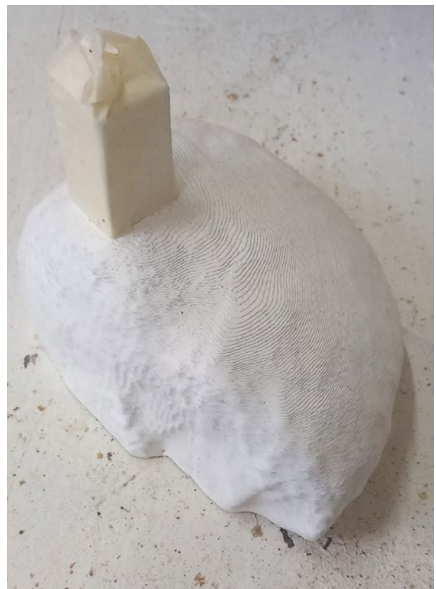
Figura 9 - Modelo impresso após aplicação de primário (Fonte: elaboração própria).
