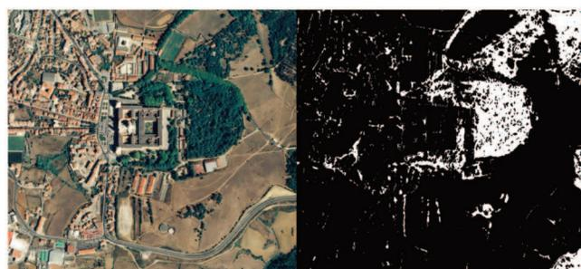
Figura 8 - Ortofoto, e respectiva avaliação, efectuada pelo *AutoDTM*
