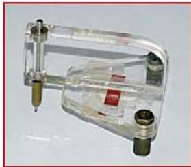
**Figura 1 – Carrinho com estilete duplo para gravar vias de comunicação a dois traços ou as curvas de nível**
