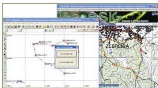
Figura 8 – Visualização de um percurso no IGeoE, a partir da aplicação GPS trackMAKER e do *plug-in* desenvolvido no IGeoE
