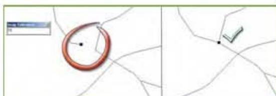
Figura 6 – Erros topológicos (linhas desligadas) assinalados pelo *Error Inspector*
