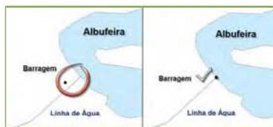
Figura 6 – Correcção de erro topológico associada às Barragens
