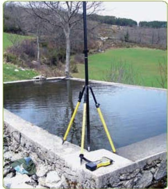
Figura 7 – Levantamento de PF com equipamento *Trimble RB*
