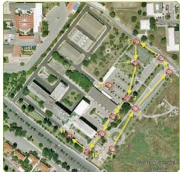
Figura 2 – Poligonal de apoio para levantamento do IGeoE
