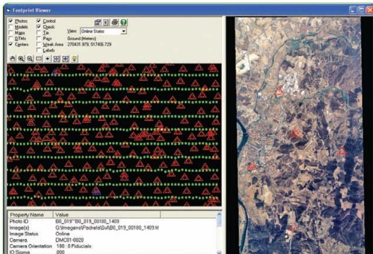
Figura 2 – Exemplo de footprint de bloco de imagens e pontos de controle
