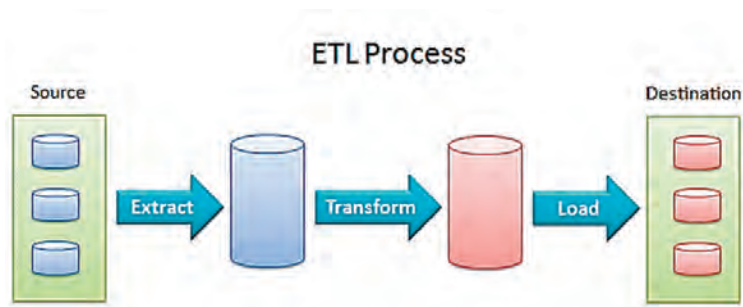
Figura 4 - Processo de ETL em ambiente de produção
