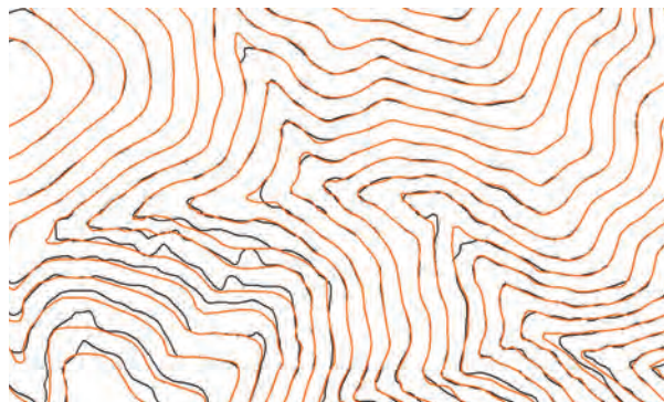
Figura 6- Diferenças entre o MDS (a preto) gerado automaticamente e o MDT corrigido manualmente (a castanho).
