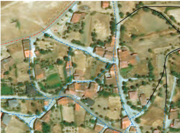
Figura 4- Exemplo do vetor de vias de uma versão anterior sobre uma imagem orto retificada atual.
