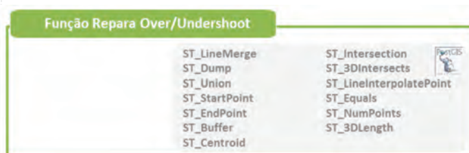
Figura 15 - Funções do PostGIS utilizadas na “Função Repara Over/Undershoots”
