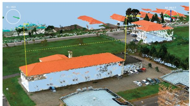
Figura 7 – Medição do comprimento de um edifício no quartelamento da AM Amadora.
