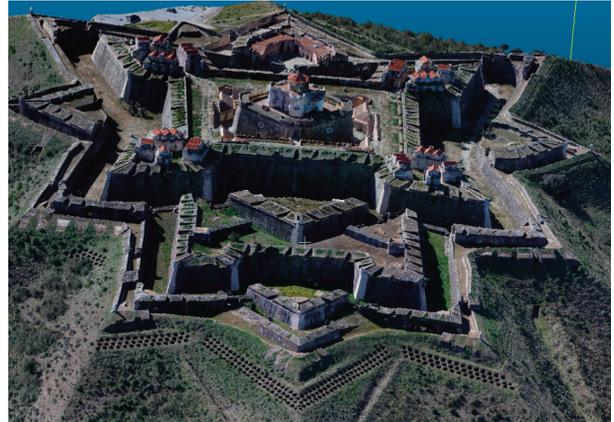
Figura 6 – Vista de perspetiva da nuvem de pontos gerada sobre o Forte da Graça em Elvas – Fonte de aquisição UX5-HD da Trimble.
