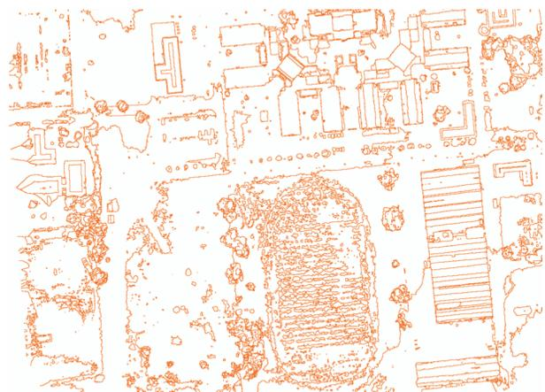
Figura 11 – Modelo do terreno representado através de curvas de nível com uma equidistância de 2 metros.
