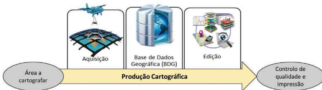
Figura 1 – Principais fases do processo de produção cartográfica
