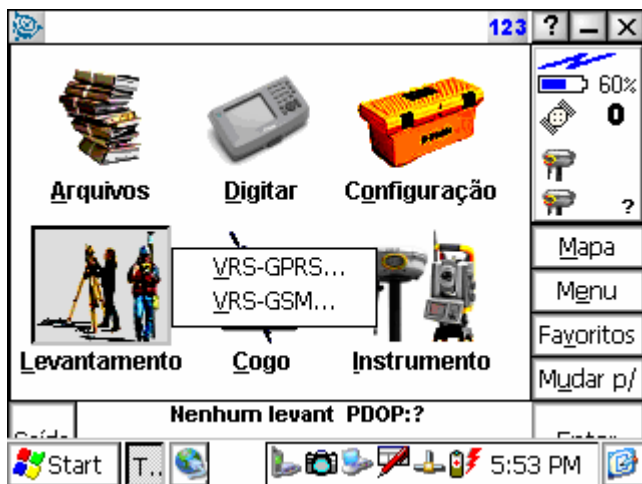
19. Selecção do estilo de levantamento (VRS-GPRS)
